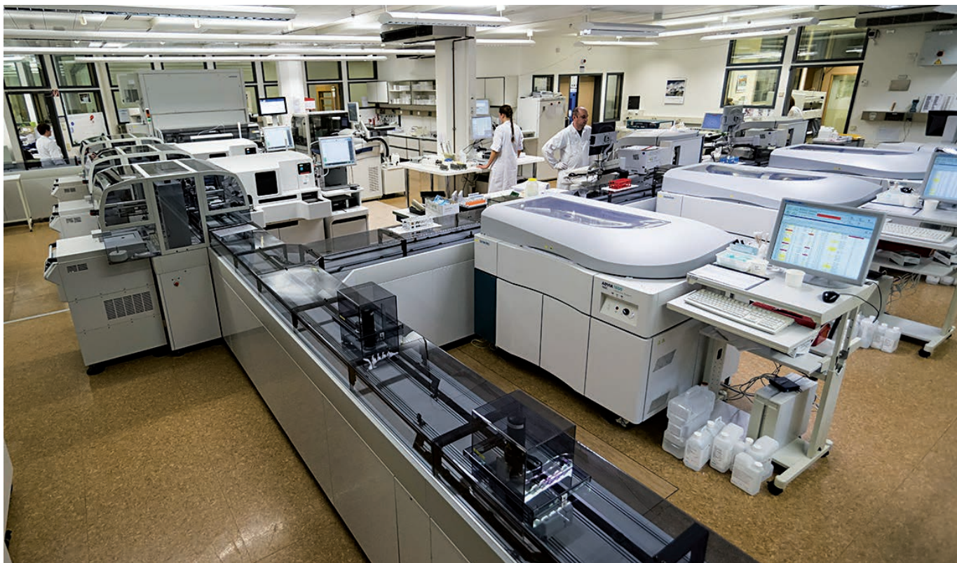
Bild 1. Überblick über die Laborstraße: links die Zentrifugen, rechts die Analysengeräte für Klinische Chemie und Gerinnung; links hinten die Probenarchivierung
