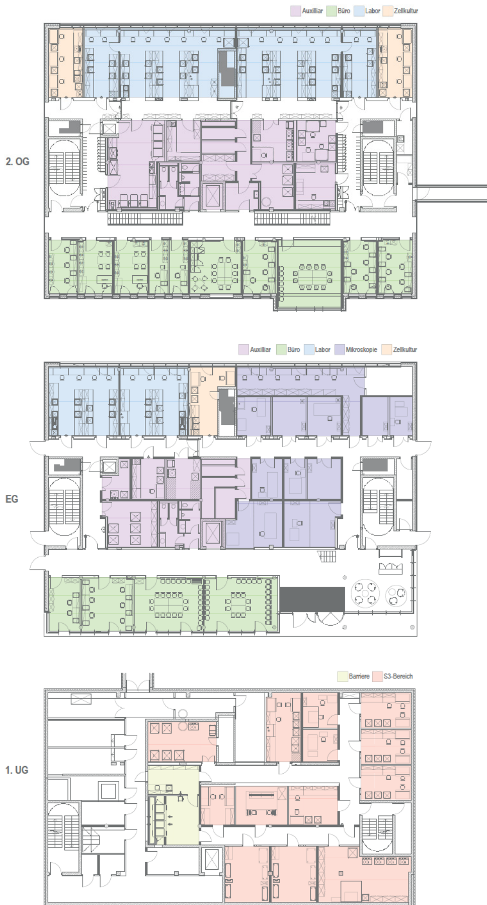
Bild 2. Gliederung der Geschosse im CIID: 2. OG: Deutlich zu erkennen ist die Ausbildung als typischer Dreibund aus Büros, Auxiliärbereich und Laborzone. Die Labore für Zellkultur liegen jeweils an den Enden der Laborzone. EG: Die rechte Hälfte der Ebene nimmt die Core Unit für die Mikroskopie auf. UG: Hinter der Barriere erstreckt sich der mehr als 400 m 2 große S3-Bereich. (Grafik: Teamplan)
