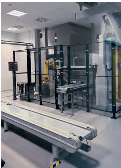
Abb. 2: In der AEMP entlastet ein Frei-Arm-Roboter die Mitarbeitenden beim Be- und Entladen der Transportwagen; Quelle: Teamplan GmbH
