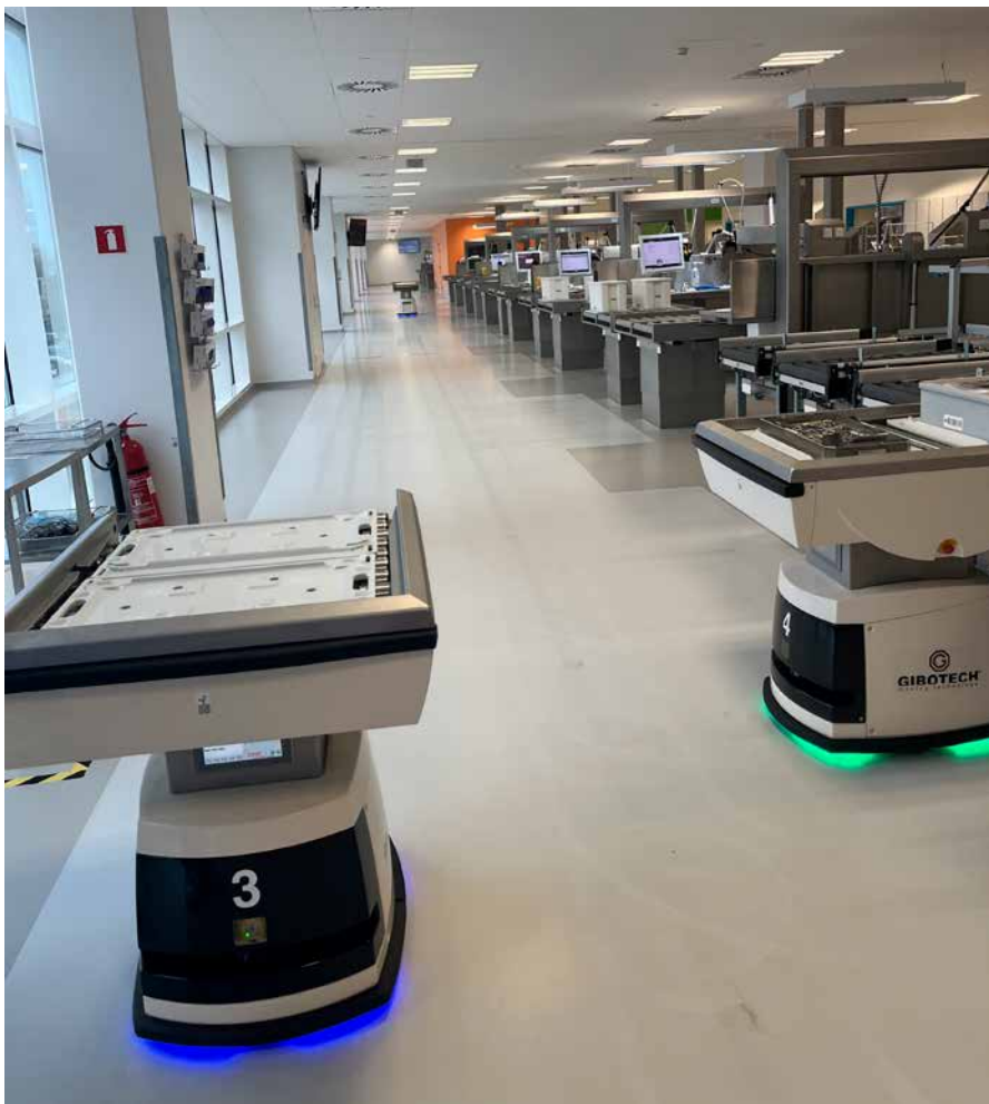
AGVs transportieren Siebe mit benutzten Instrumenten zum Nassarbeitsplatz. Fotos: Teamplan GmbH
